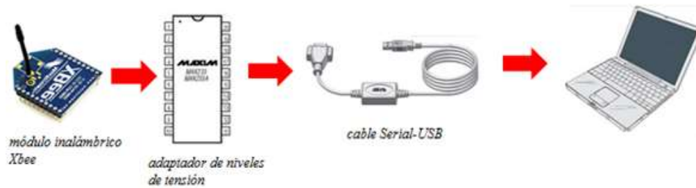
Figura 1.3 Recepción de datos, y acondicionamiento de la señal para ser procesada en la computadora.
