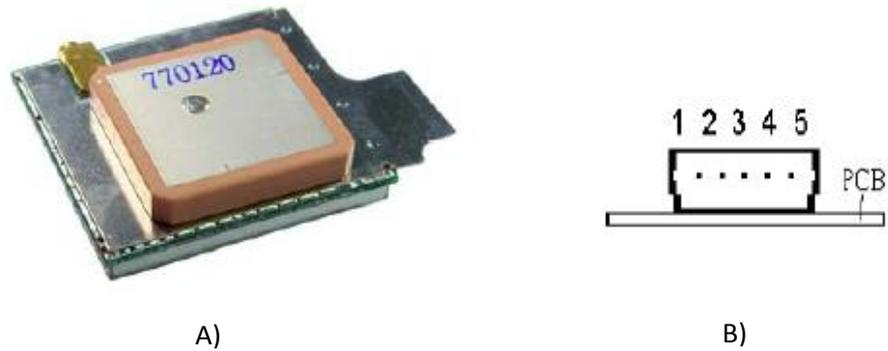
FIGURA 1.10 A) RECEPTOR EM-408 B) MAPA DE PINES DEL RECEPTOR EM-408
