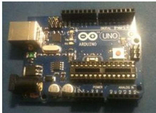
**FIGURA 5.24 ARDUINO UNO SIN MICROCONTROLADOR ATMEGA328**
