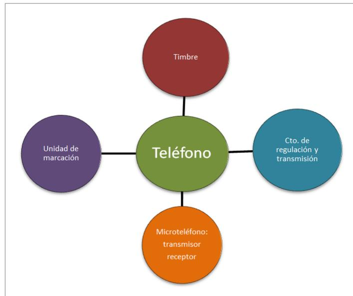
Figura 1.4. Partes del teléfono (Elaboración propia, 2013)
