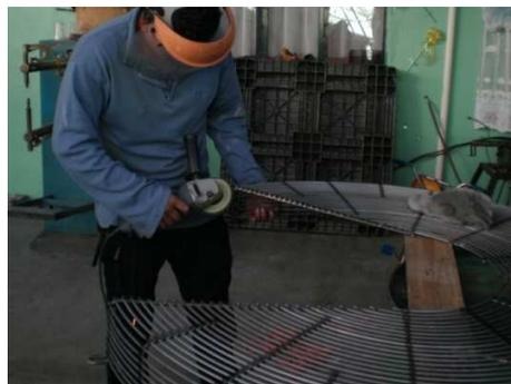
Fig. 2.10 Corte de pieza redonda
