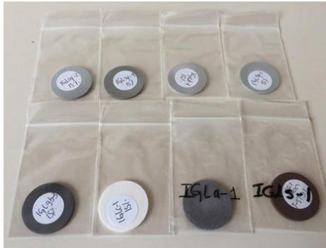
Figura 3.5 Conjunto de las 8 muestras IGL's utilizadas en la calibración del equipo X-Calibur.
