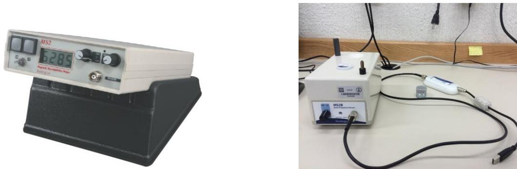
Figura 3.10 Susceptibilímetro Bartington MS2 y Susceptibilímetro MS3 conectado al sensor MS2B.
