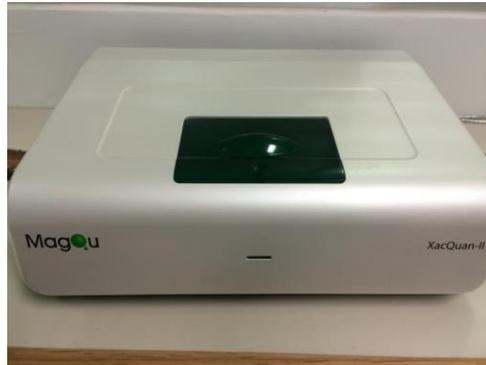
Figura del Magnetosusceptibilímetro X<sub>AC</sub>QUAN de la marca Magou.
