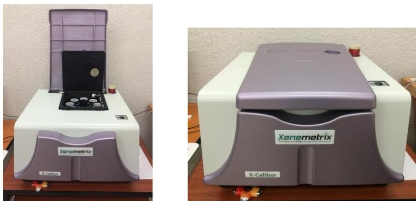
Figura 3.2 Equipo X-Calibur utilizado en el estudio de FRX.
