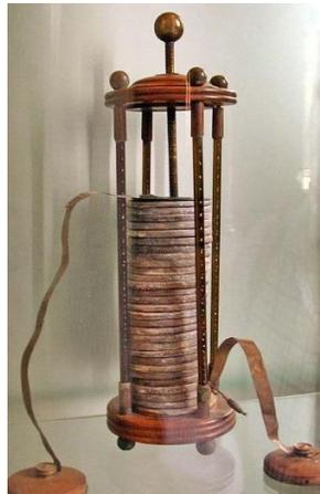
**Fig. 1.09, Batería de celdas conectada en serie por Alessandro Volta (1745 - 1827).**
