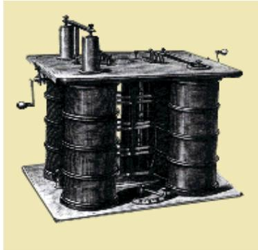
**Fig. 1.14, Primer transformador inventado por Gaulard-Gibbs**
