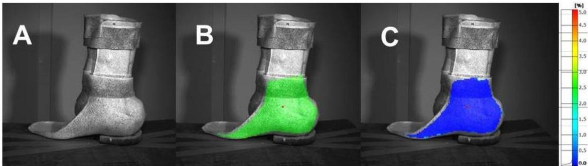
**Figura 40.** Verificación de la preparación superficial de M1. A) Preparación superficial. B) Análisis del tamaño de la máscara. C) Análisis de deformación.
