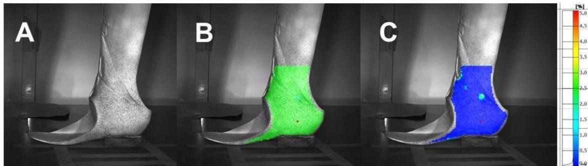
**Figura 39.** Verificación de la preparación superficial de F1. A) Preparación superficial. B) Análisis del tamaño de la máscara. C) Análisis de deformación.
