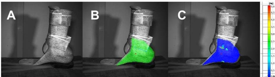
**Figura 41.** Verificación de la preparación superficial de M2. A) Preparación superficial. B) Análisis del tamaño de la máscara. C) Análisis de deformación.
