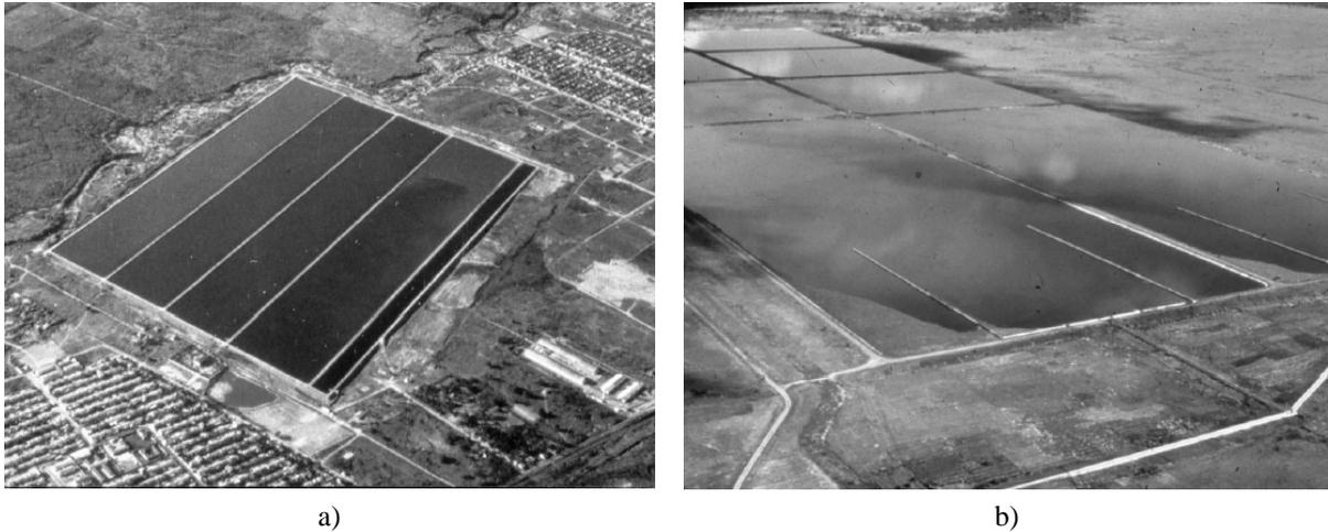
**Figura 3.3.** Sistema de laguna de estabilización, compuesta por lagunas anaerobias, facultativas y de maduración (Peña & Mara, 2004)
