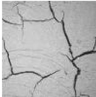
**Figura 3.31.** Ejemplo del agrietamiento que puede ocurrir en arcillas compactadas cuando se secan (Daniel & Wu, 1993)
