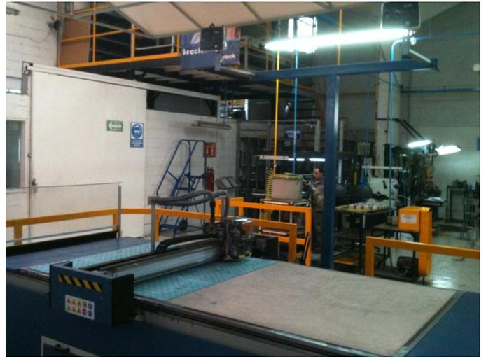
Máquina CNC de corte por cuchilla
