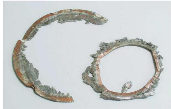
**Figura 10. Juntas con deformidades y fallas. En la imagen de la derecha, el lubricante erróneo redujo la resistencia a la fricción de esta junta en el flange, permitiendo que se extruyera, debilitando al EPDM y reduciendo la resistencia a la compresión de la junta.**
