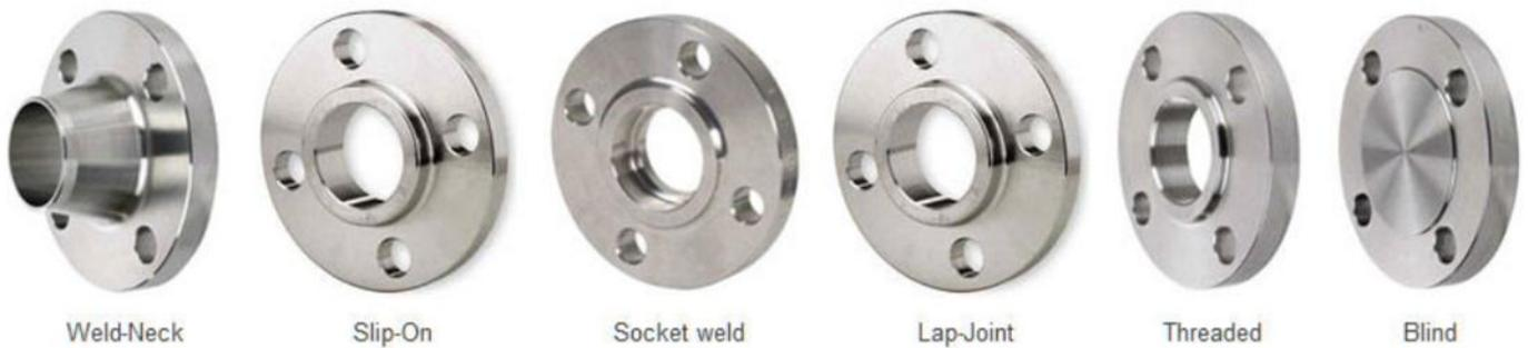
Figura 8. Bridas con sus nombres en inglés. Todas las bridas que se muestran están incluidas en los estándares ASME y ASTM. La norma ASME B16.5, describe las dimensiones, las tolerancias dimensionales, etc. Y la norma ASTM, las distintas calidades de los materiales.
