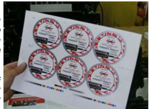
*Hay otro aspecto en este asunto de los papeles autoadhesivos, y es que, en algunas imprentas, juntan saldos de diferentes marcas de adhesivos, con diferentes espesores en el soporte. Esto impide que el medio corte sea perfecto.*
