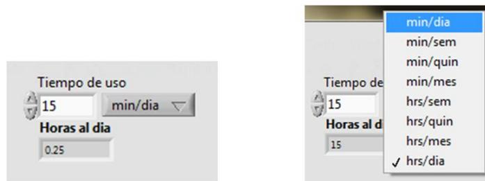
Figura 4.4-2. Controles, indicadores y el menú de conversiones del subprograma Convertidor.
