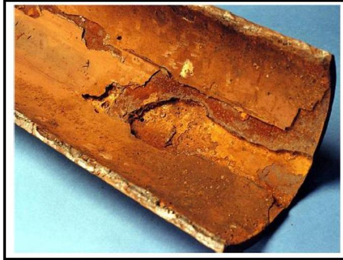
**Figura 2.6 - Corrosión por picadura (Papoola, 2013).**
