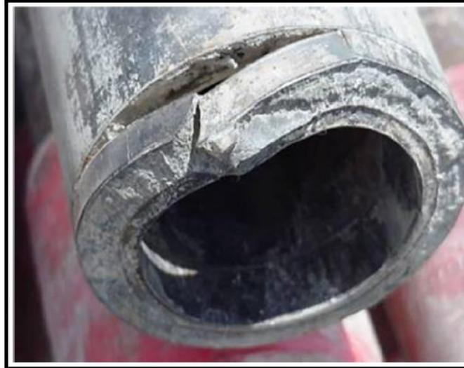
**Figura 2.7 - Tubería de producción bajo los efectos de la corrosión amarga (Papoola, 2013).**
