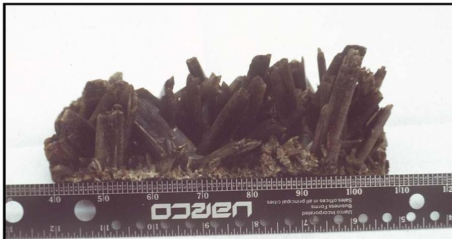
**Figura 1.21 - Cristales de sulfato de calcio extraídos de una línea de flujo al Oeste de Texas (George E. King Engineering).**
