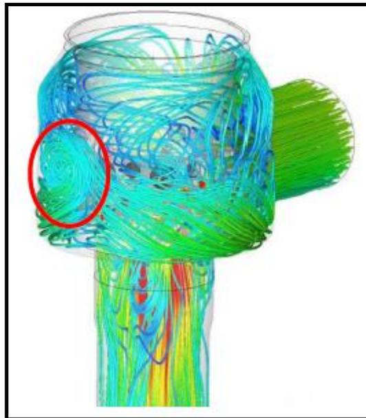
**Figura 2.3 - Modelado del impacto de partículas por medio de CFD (Linh Le, Chevron, 2012).**
