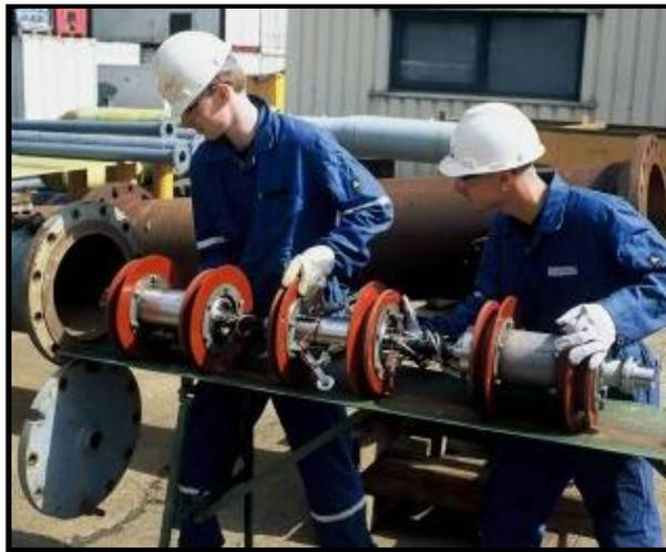
**Figura 1.18 - Inserción manual de un diablo en una tubería**
