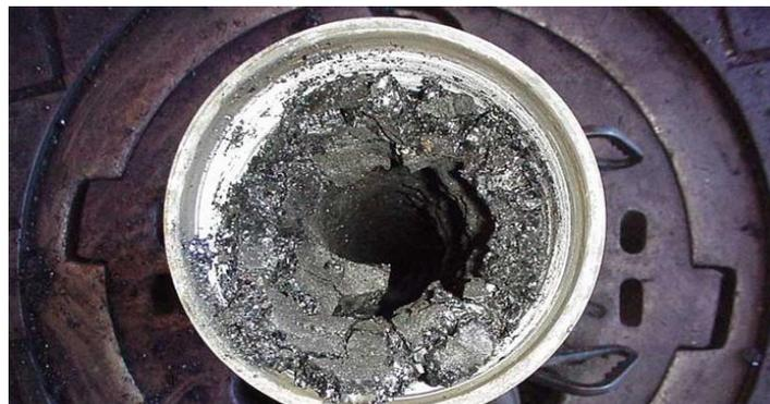
**Figura 1.13 - Depósito asfáltico obstruyendo una tubería (Baker-Huges, 2014).**
