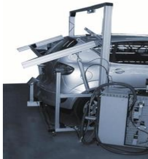
Figura [2.7] Banco de pruebas dedicado a la apertura y cierre de cofres y cajuelas.
