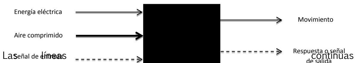
Figura [3.3] Diagrama funcional de un banco de pruebas que surge a partir de su descomposición funcional también denominado "Caja negra".
