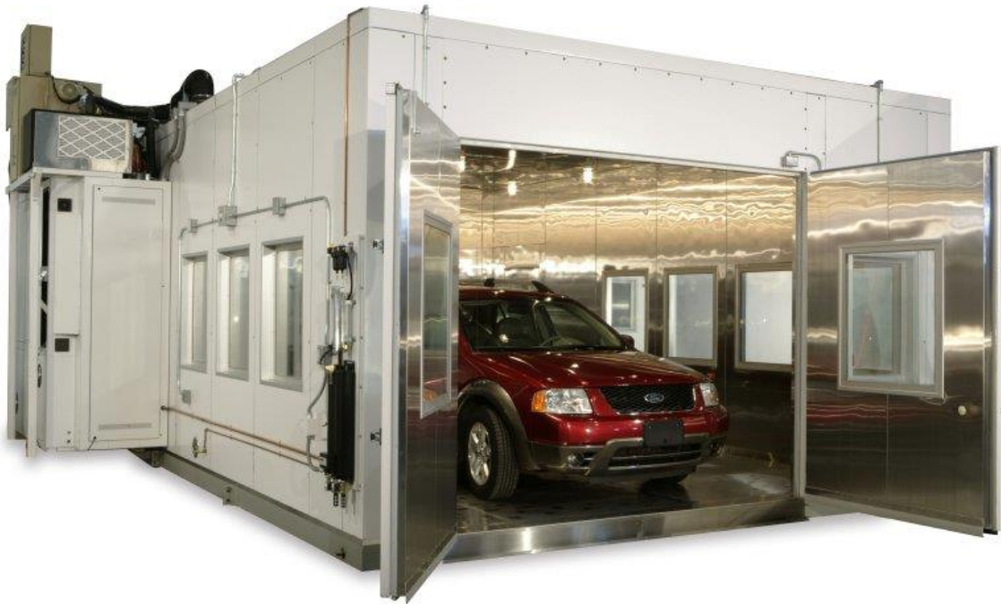
Figura [4.0] Cámara ambiental 4
