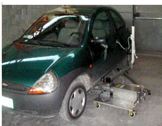
Figura [2.5] Banco de pruebas de función externa acoplable a ambos laterales del vehículo.
