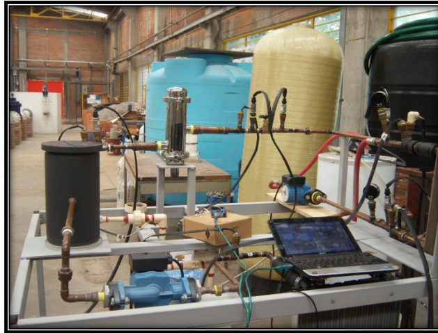
Figura 57. Estructura final del circuito con sensores digitales.
