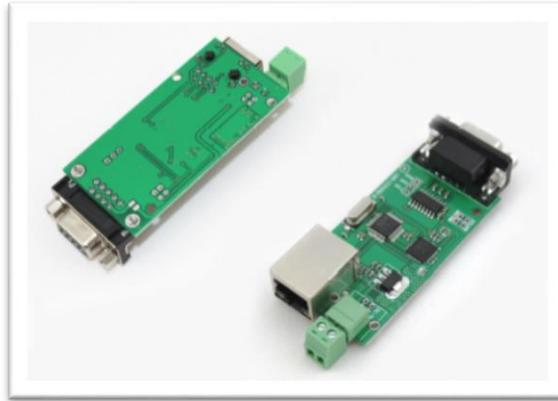
**Figura 1.2 1** Módulo ethernet. Electrónica estudio (Estudio, s.f.) Recuperado el 5 marzo del 2013 de Electrónica estudio: <http://www.electronicaestudio.com>
