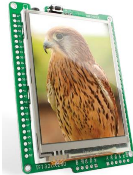
Figura 49: Tarjeta de desarrollo con PIC18FJ.
