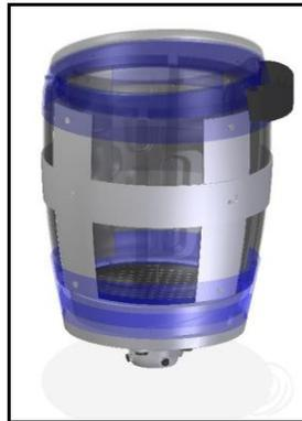
Figura 6. Finalmente con el ensamble de las piezas forman el socket autoajutable [1]
