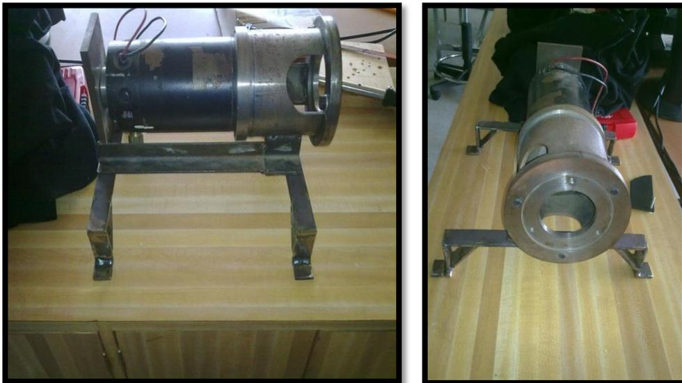
**Fig. 29. Motor-dinamómetro para medir el par de entrada al RVCEM.**
