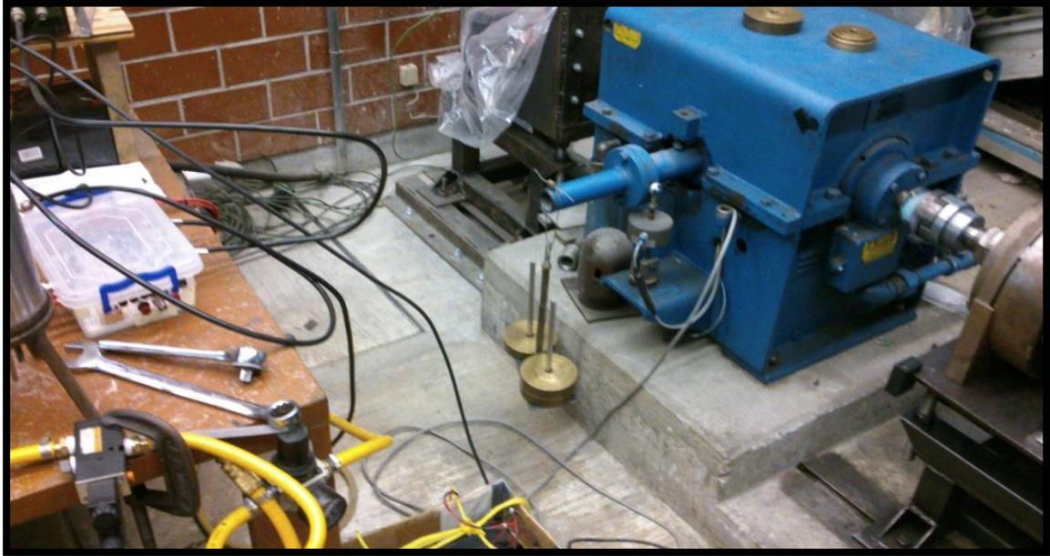
**Fig. 30. Calibración del dinamómetro de banco DYNAMATIC.**
