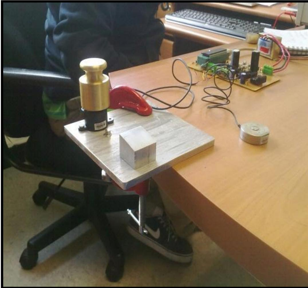
**Fig. 18. Calibración de las celdas de carga.**
