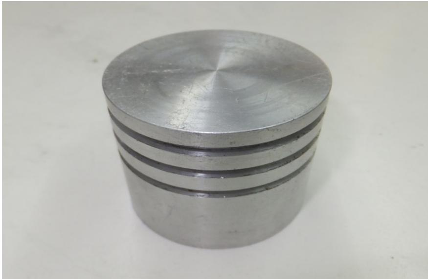
Figura 4.18 Maquinado del pistón en torno.
