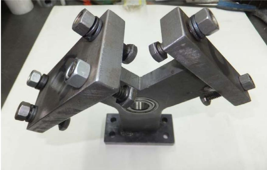
Figura 4.40. Maquinado final de la base del motor.
