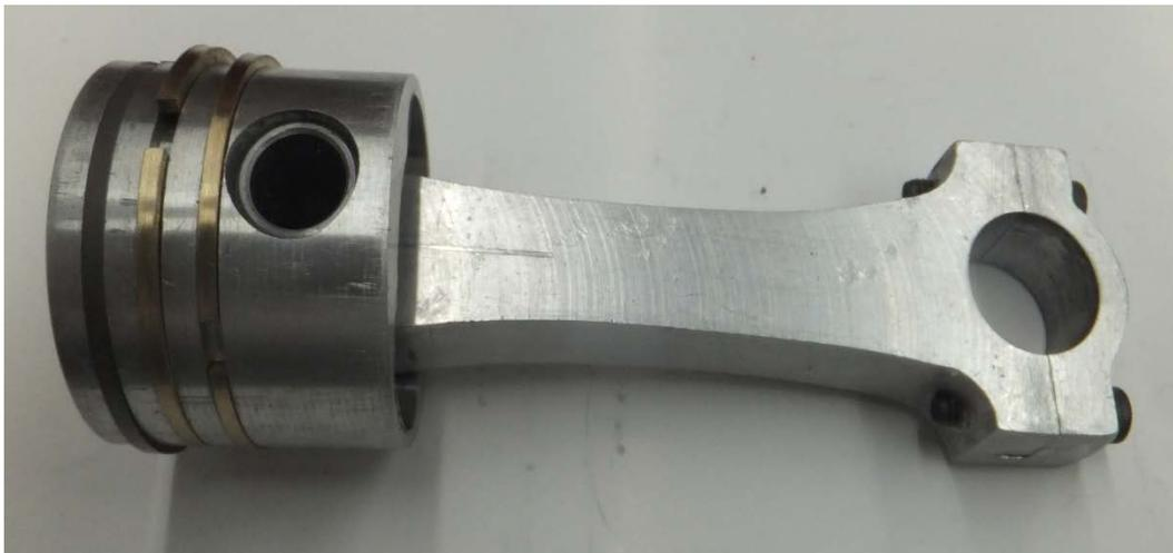
Figura 4.48. Anillos foco caliente.
