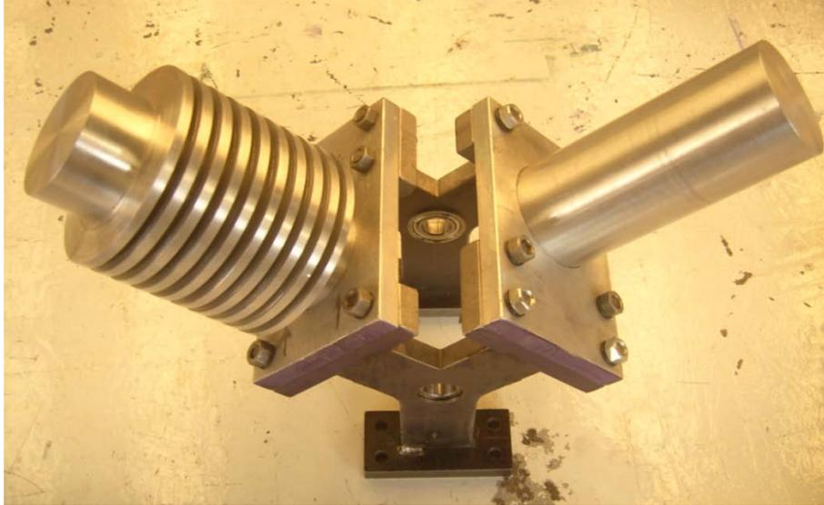
Figura 4.42. Arreglo de motor en “V” a 90°.
