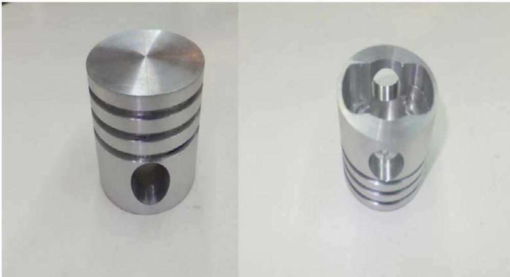
Figura 4.19 Maquinando final del pistón.
