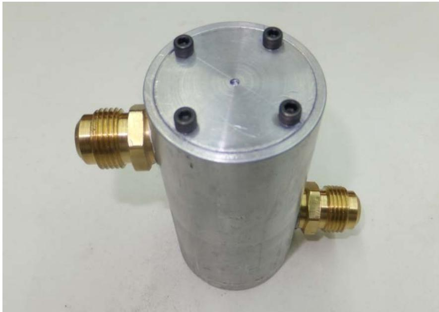
Figura 4.44. Maquinado final del regenerador.
