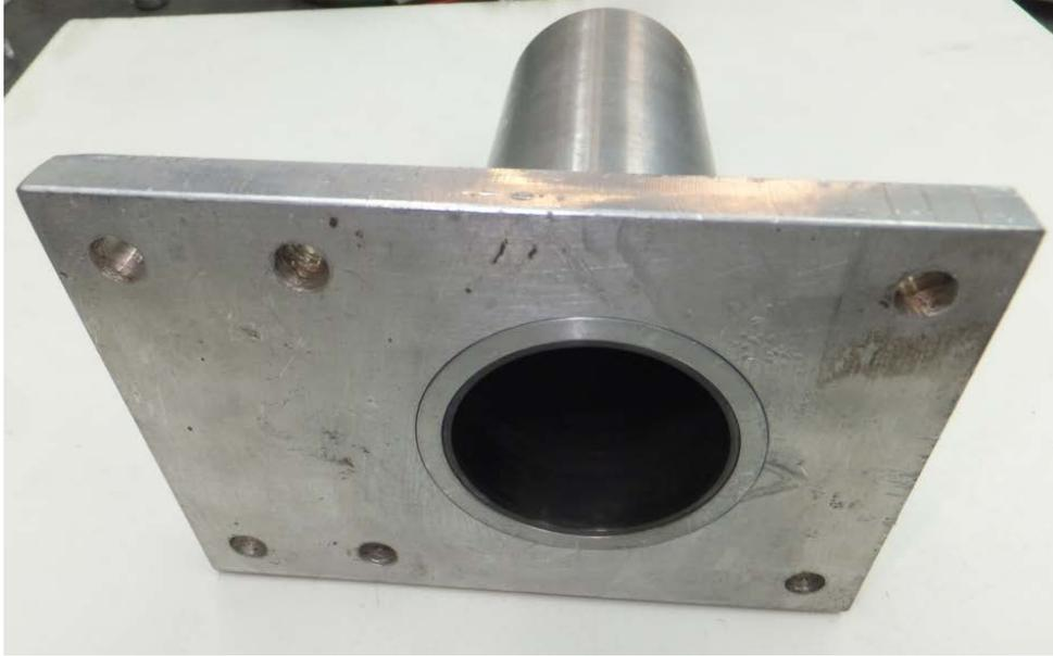
Figura 4.38. Cilindro de calentamiento con su base.
