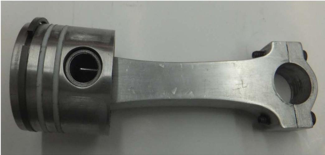
Figura 4.47. Anillos del foco frío.
