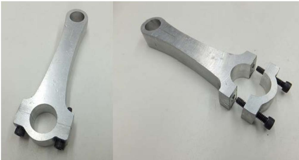
Figura 4.26 Maquinado final de la biela.
