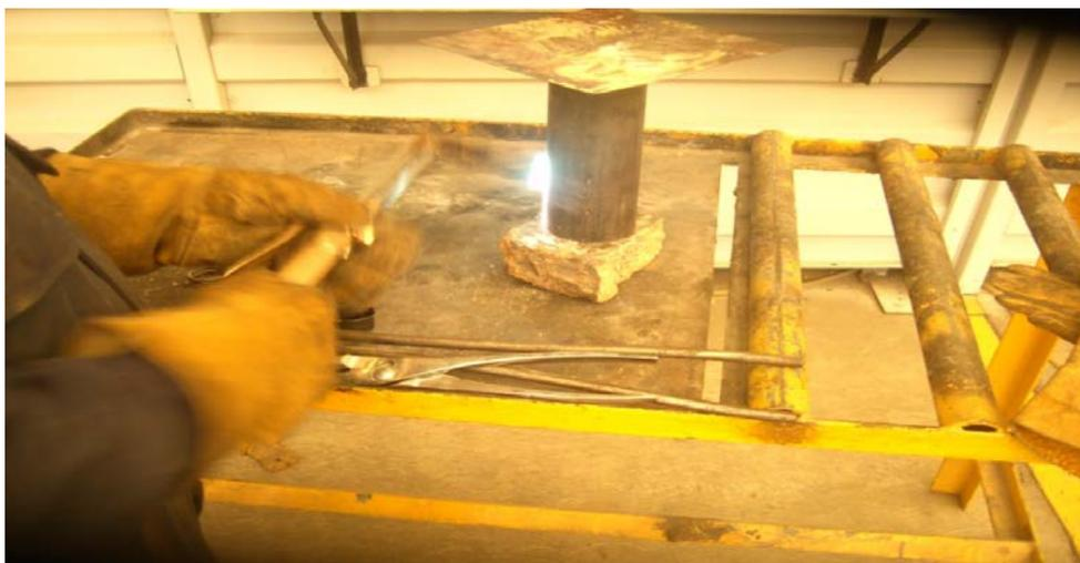
Figura 4.14 Proceso para dilatar cilindro de aluminio.
