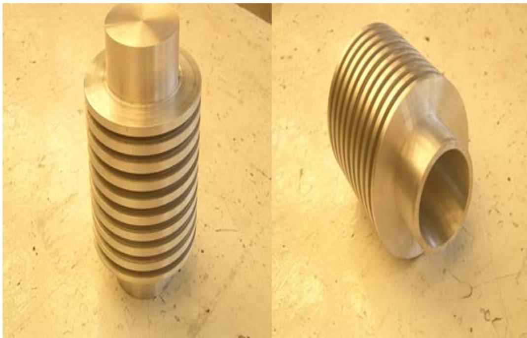
Figura 4.5 Pieza final del Cilindro de enfriamiento.
