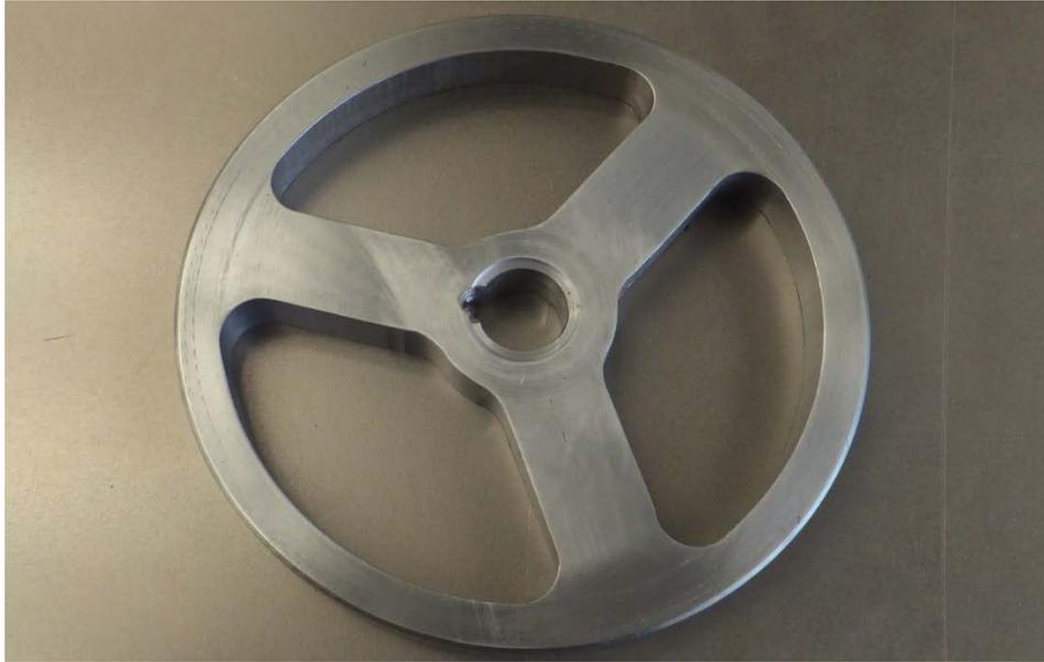
Figura 4.33. Volante de inercia.
