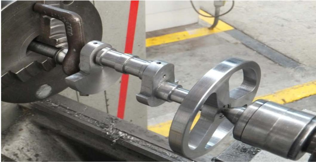
Figura 4.49 Ensamble del cigüeñal y volante de inercia.
