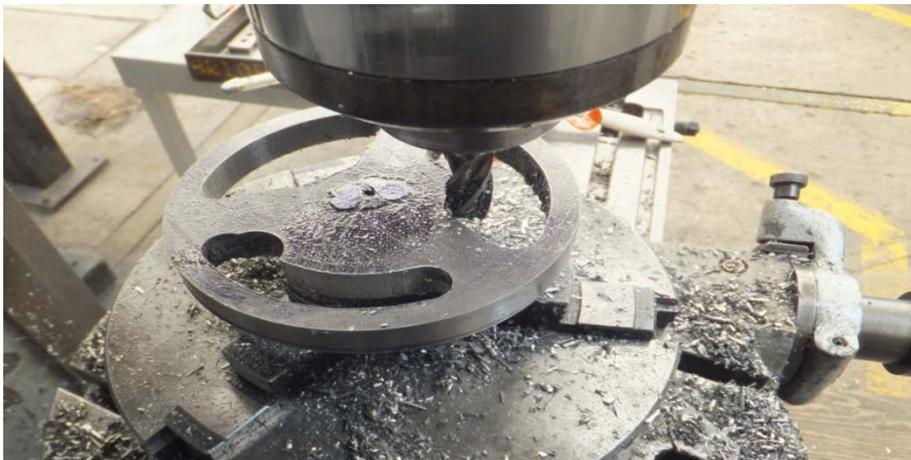
Figura 4.32 Fresado del volante.
