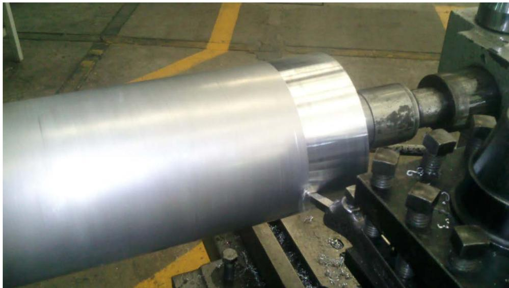
Figura 4.7 Maquinado del cilindro del foco caliente.
