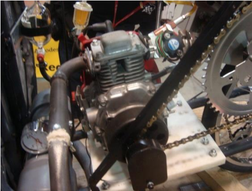
Fig.1. 9 Sistema de transmisión del prototipo Black Widow Tear de CALPOLY.
