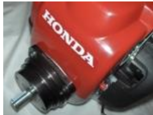
Fig. 3.13 Clutch centrífugo acoplado en motor GXH50.
