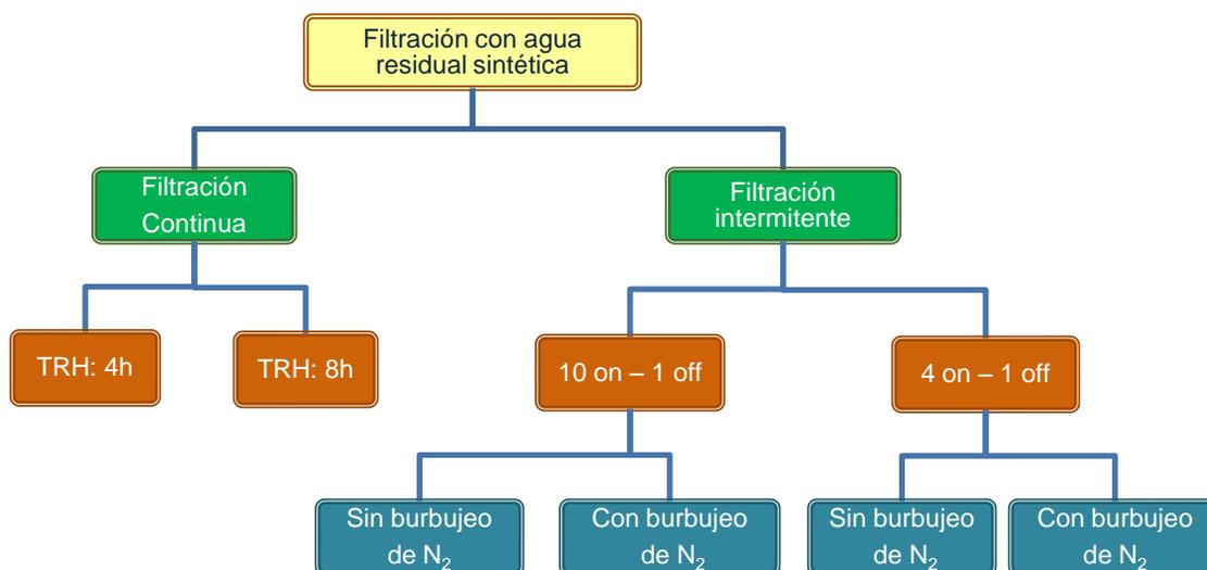
**Figura 3.3. Modos de operación en pruebas con agua residual sintética**
