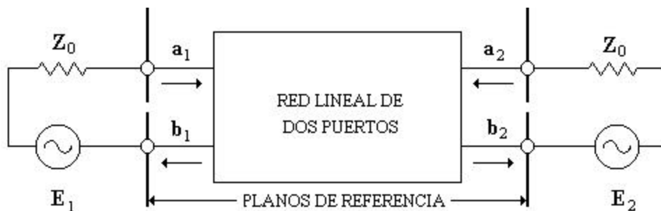
Figura 1.3 Definición esquemática de los parámetros S .
