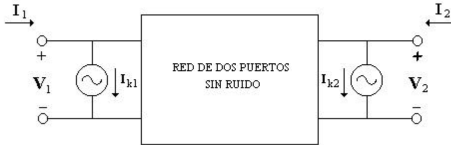
Figura 1.12 Forma de admitancia de una red de dos puertos con ruido.
