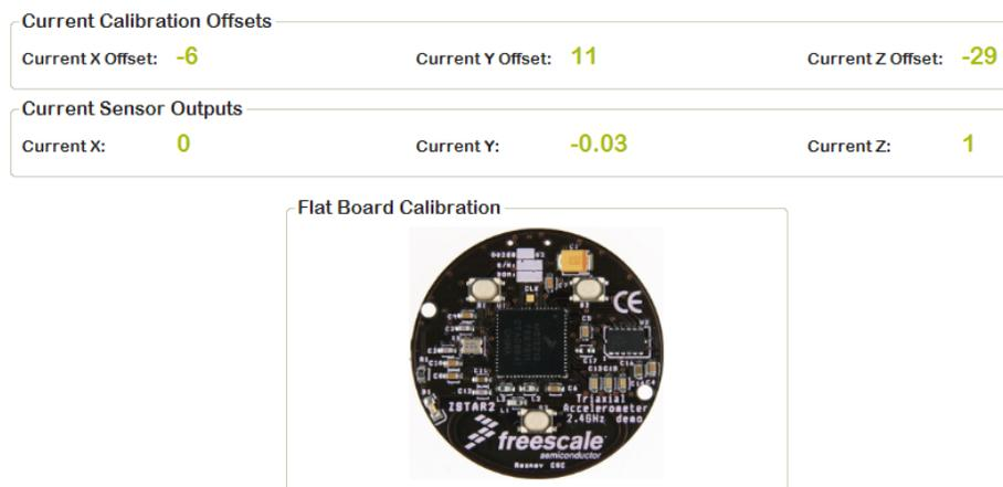
Figura 3. 11 Adquisición de los valores de offset en cada eje.
