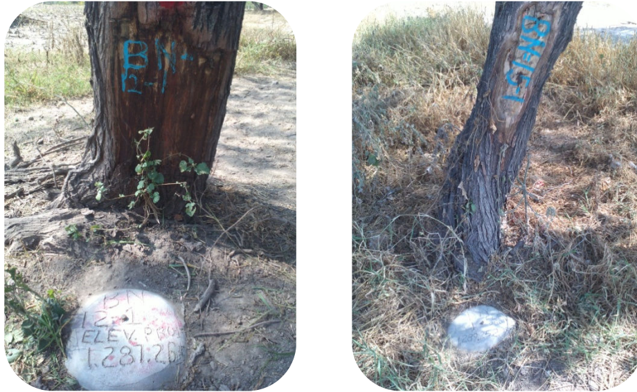
IMAGEN 4.9 BN(12-1) - BN(15-1) Ubicados en campo sobre varilla con mojonera.
