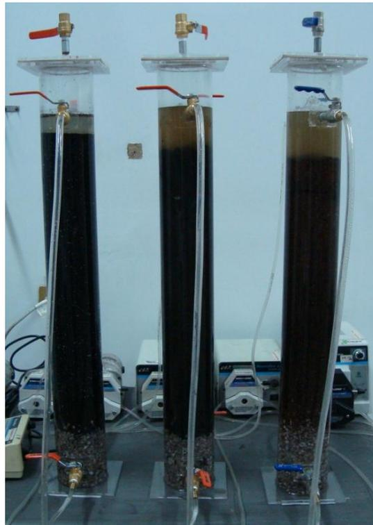
**Figura 4.2 Biofiltros anaerobios**
