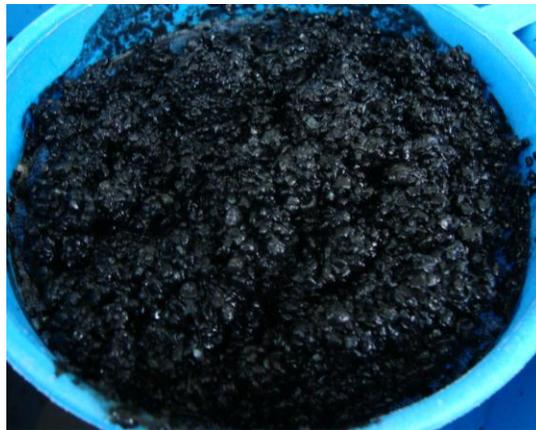
**Figura 5.1** Lodo granular para inoculación
