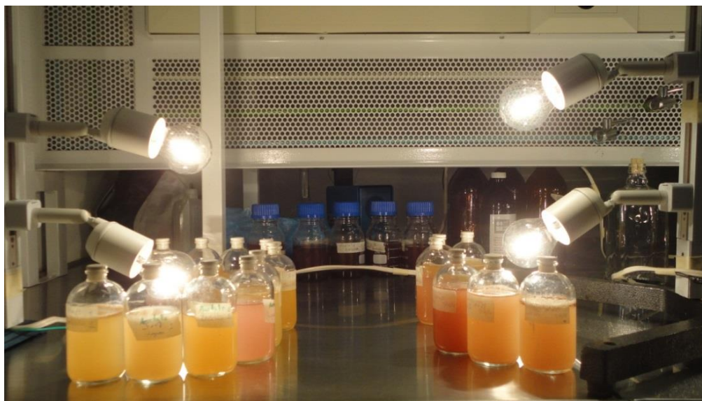
Figura 2.2. Selección de inóculo productor de hidrógeno a partir de 3 diferentes fuentes de origen.
