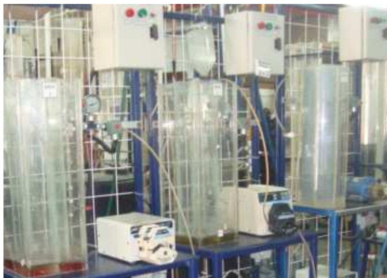
Figura 3.2. Fotografía de los biorreactores con membrana sumergida.
