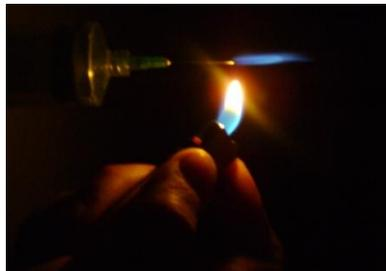
Figura 3.7 Pruebas de inflamabilidad a biogás
