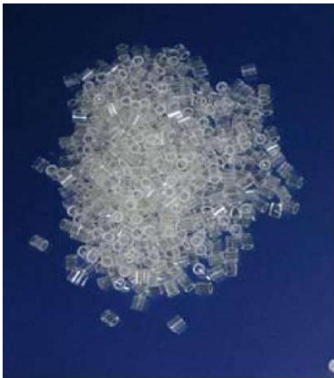
**Figura 11** TiO<sub>2</sub> en forma inmovilizada sobre pequeños cilindros o anillos de vidrio Pyrex®.
