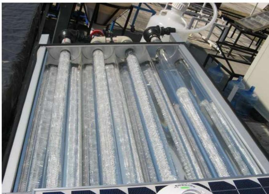
**Figura 14.** Varillas con TiO<sub>2</sub> inmovilizado introducidas dentro del reactor.
