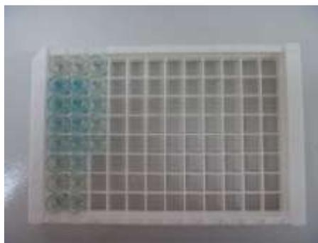
**Figura 18** Reacción de color para evaluar la concentración de CBZ en la solución.
