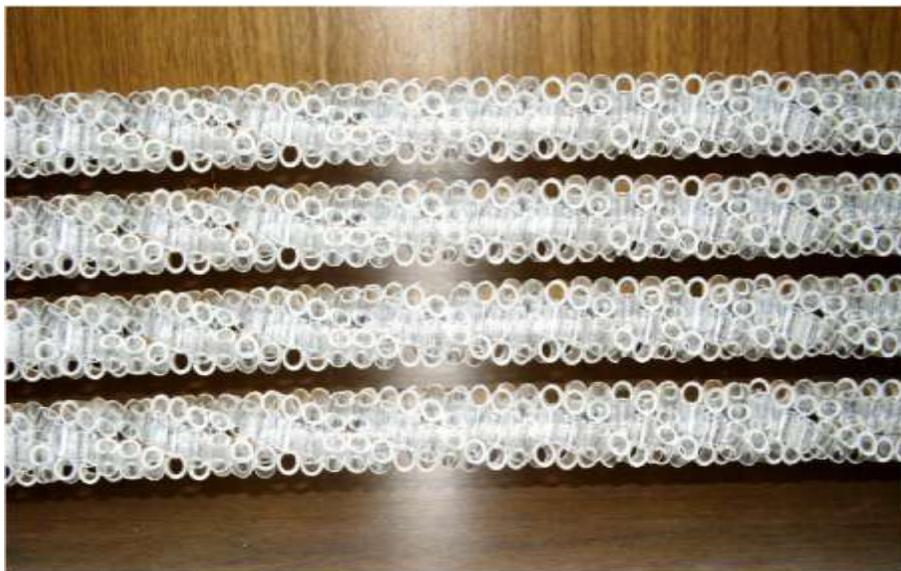
**Figura 13.** Varillas con TiO<sub>2</sub> inmovilizado.
