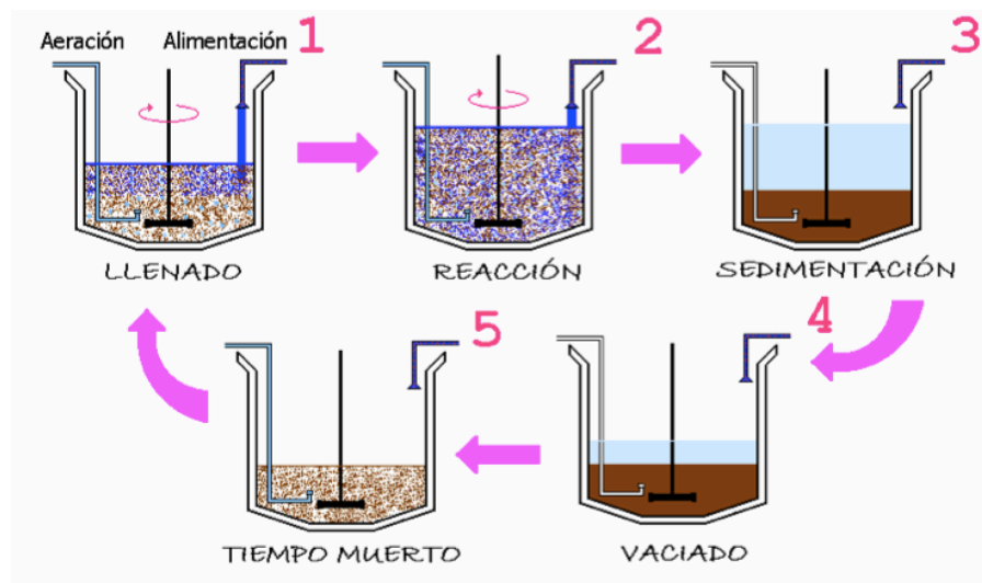
Figura 2.1: Fases de operación de un SBR. Adaptado de [Moreno-Andrade, 2006]
