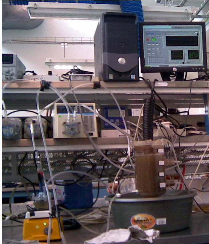
Figura 3.2: Reactor aerobio SBR automatizado.
