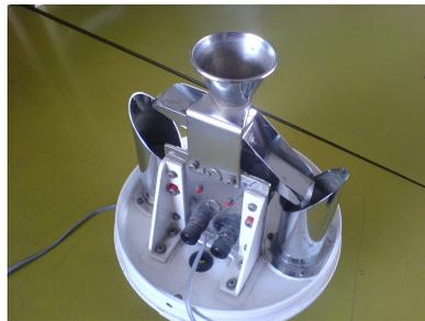
**Fig. 3.10.** Fotografía del pluviómetro usado.
