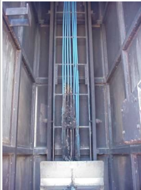
Cable libre de halógenos Supera el ensayo de no propagación del incendio, sólo una mínima parte del cable resulta dañada
