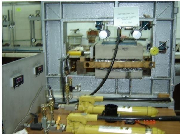
Figura 7. Equipo para la realización de pruebas de corte directo en laboratorio.
