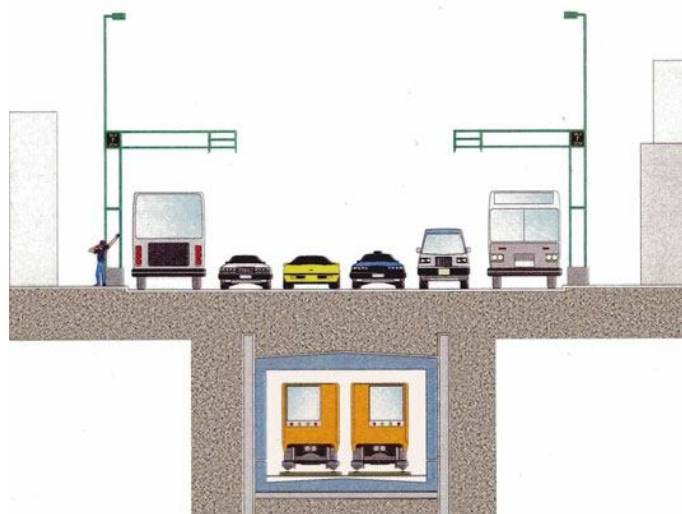
Figura 3. Sección en cajón subterráneo
