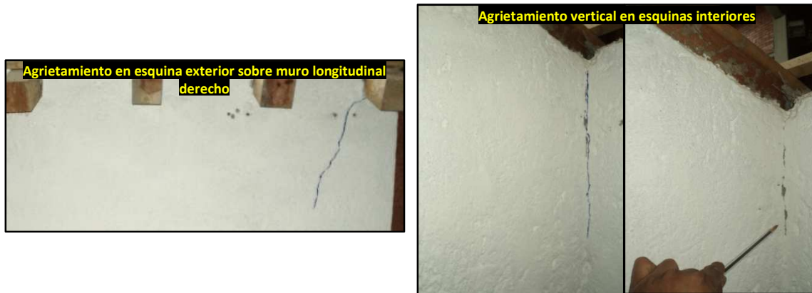
Figura 4.5 Otros daños en el modelo reforzado (MOD2) al final del programa de pruebas
