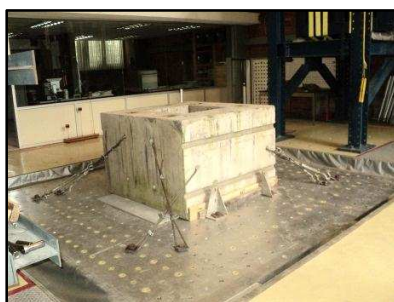
Figura 3.34 Masa equivalente sobre la mesa vibradora
