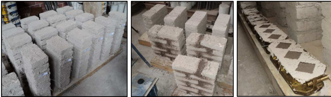
Figura 3.13 Especímenes de adobe: pilas (Izquierda), muretes (Centro) y cubos de mortero (Derecha)
