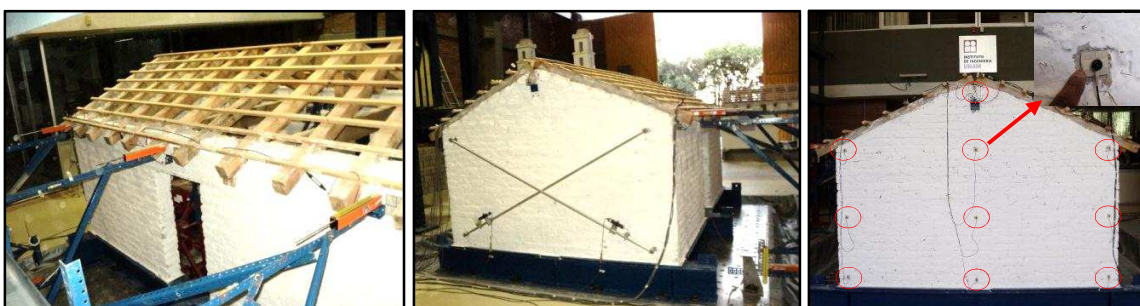
Figura 3.39 Transductores para medir desplazamientos absolutos en muros (Izquierda), deformaciones a cortante (Centro) y desplazamientos en muro transversal con LED's (Derecha)
