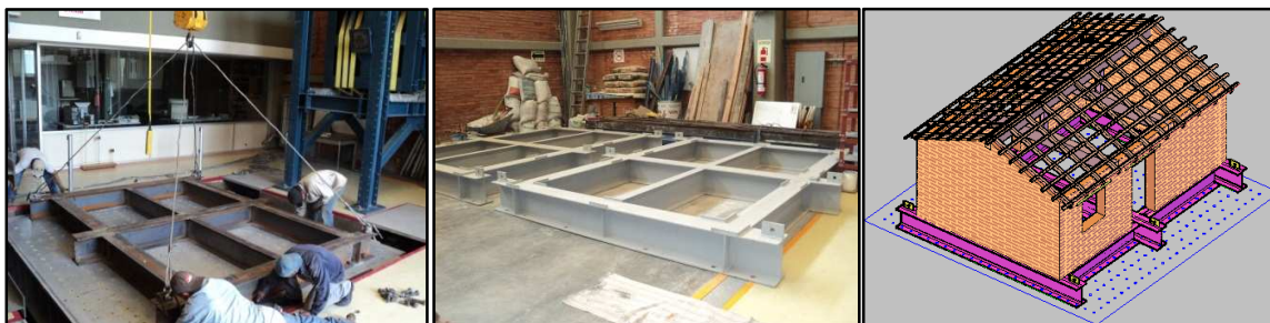
Figura 3.21 Base de acero para el traslado y fijación del modelo en la mesa vibradora
