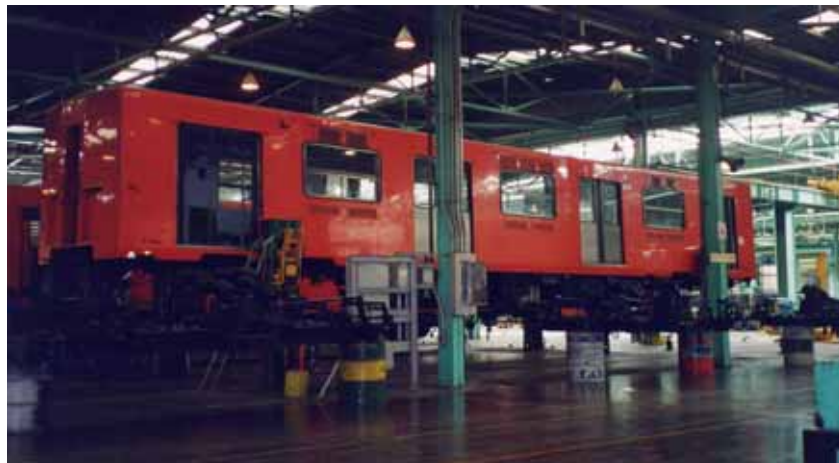
FIG. 1.1 ENSAMBLE DE BOGUI CON CARROCERÍA
