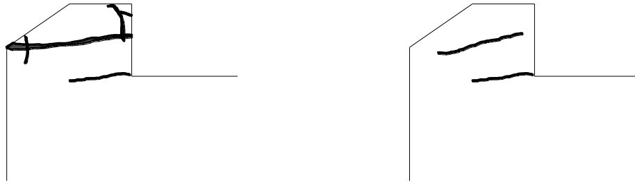
Figura 1.3. Fallas de topes sísmicos por tensión diagonal
