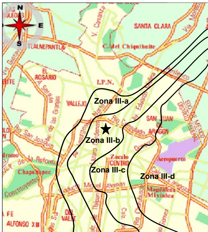
Fig 3.51 Ubicación del conjunto Torre Mayor-Cuerpos Bajos en la zonificación sísmica del Valle de México, según las NTC-Sismo del RDF-04
