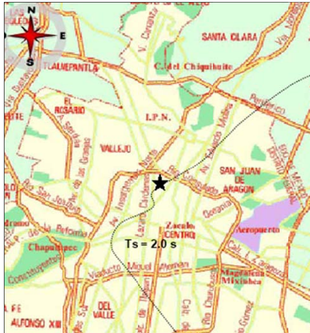
Fig 3.53 Periodo dominante del movimiento del suelo ( T_s ) en la zona donde se ubica el conjunto Torre Mayor-Cuerpos Bajos, según las NTC-Sismo del RDF-04
