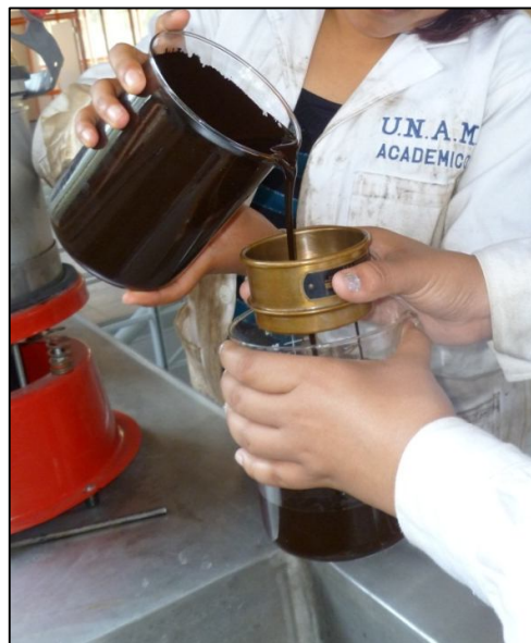
Fig. 39 Prueba de Retenido en malla No. 20
