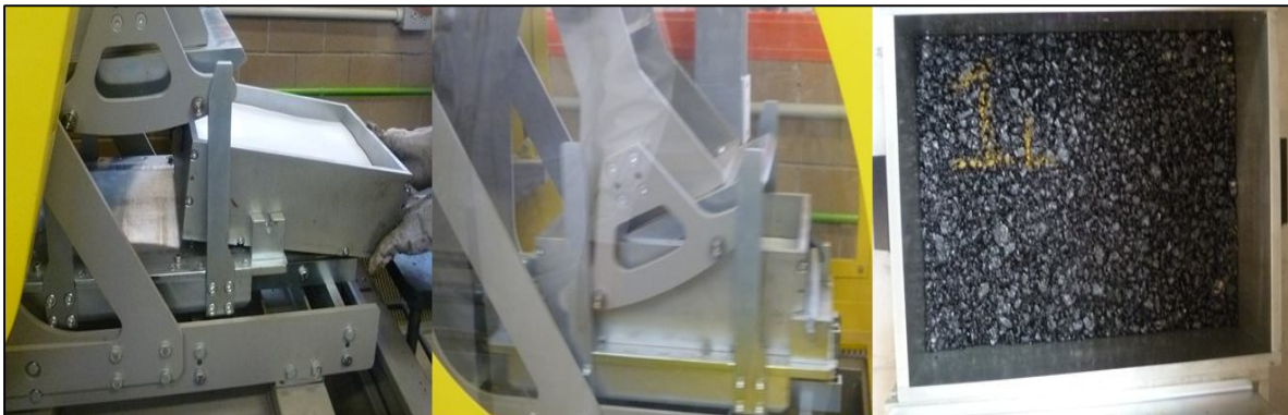
Figura g. Proceso del Compactador Dinámico para placas asfálticas
