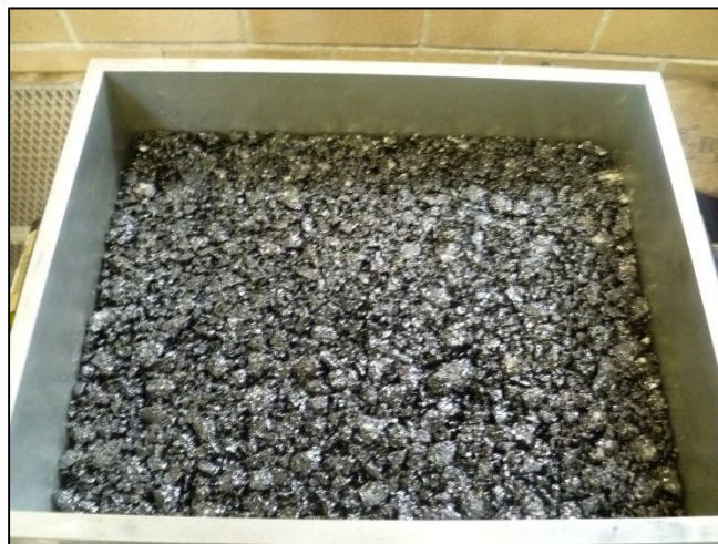
Figura i. Distribución de mezcla asfáltica abierta sobre una mezcla asfáltica cerrada.
