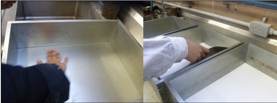
Figura e. Disposición de moldes para la colocación de mezclas asfálticas
