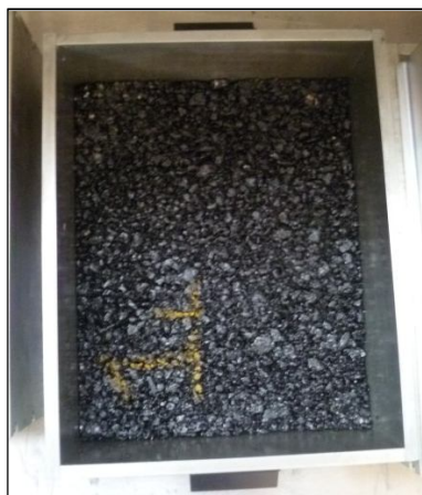
Fig. 49 Placa de mezcla densa en reposo
