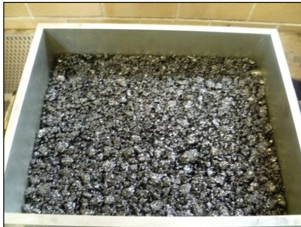
Fig. 50 Placa de mezcla abierta en reposo
