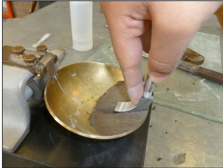
Fig. 32 Prueba de límite líquido por el método de Casagrande
