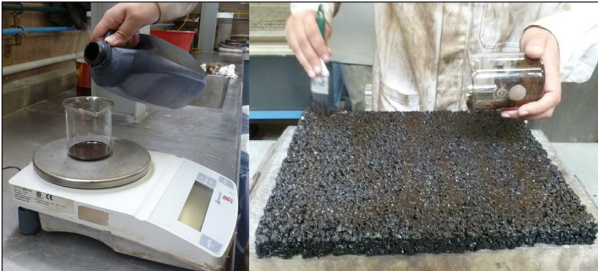
Figura h. Colocación de Emulsión de acuerdo a su dosificación situada
