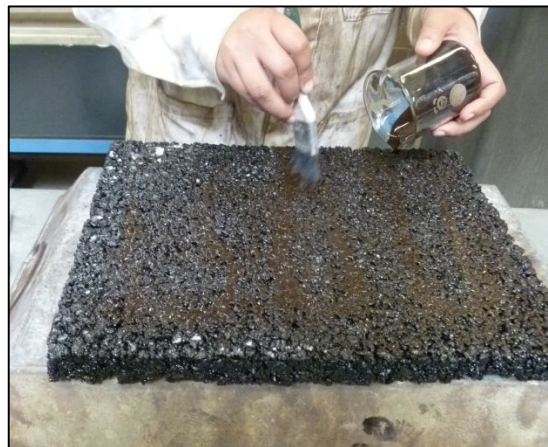
Fig. 52 Aplicación de emulsión en la placa densa
