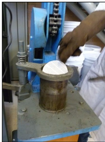
Fig. 46 Molde listo para compactar
