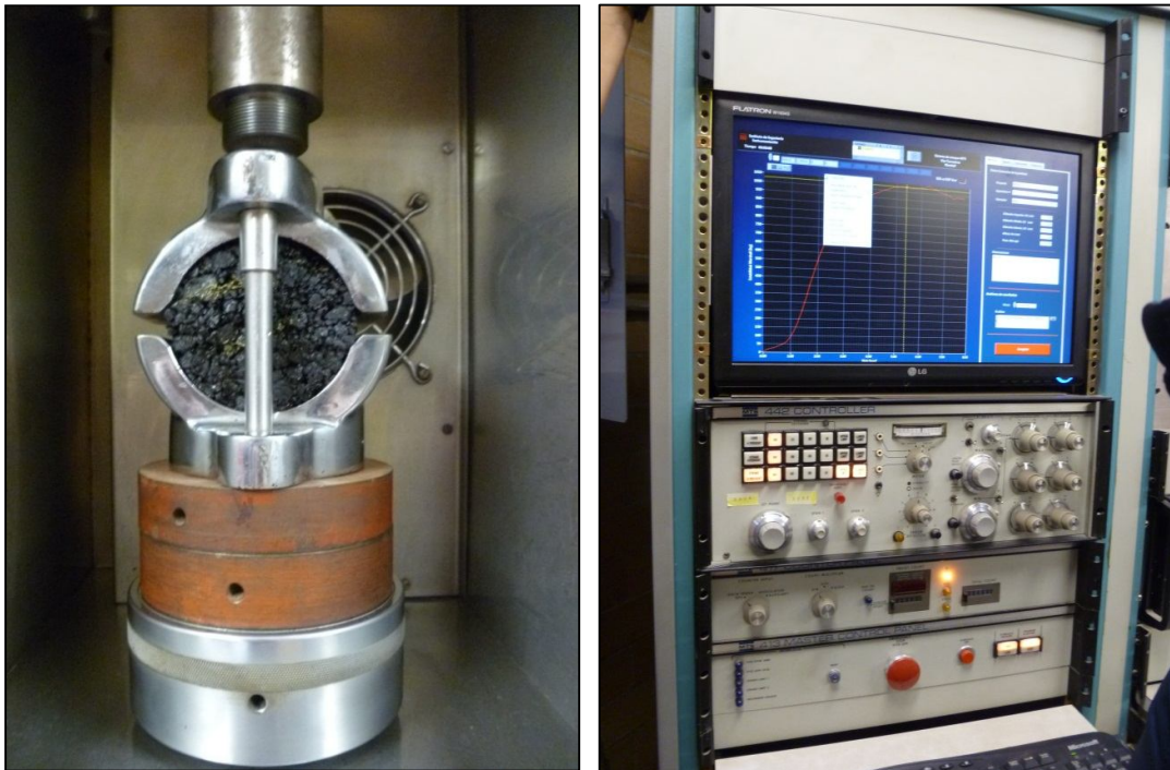
Fig. 58 Ensayo de Corte
