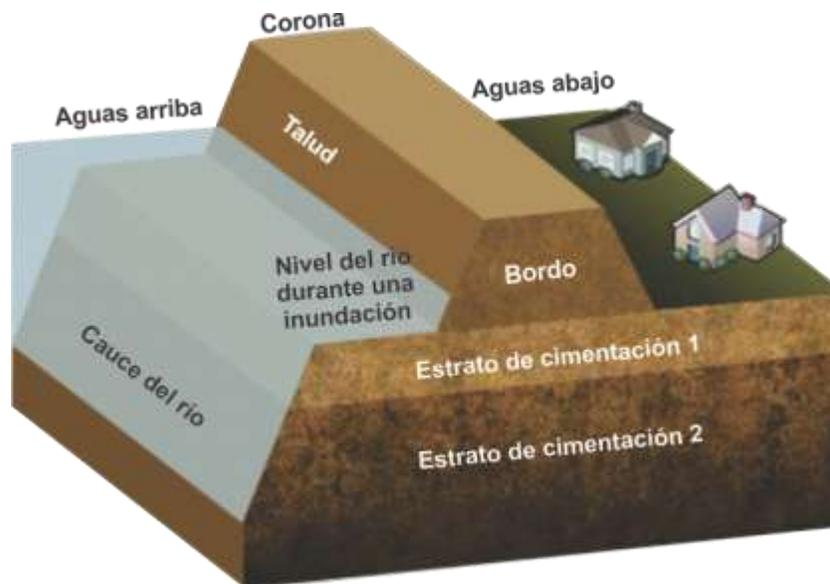
**Fig. 1-14** Componentes típicos de un bordo de protección.
