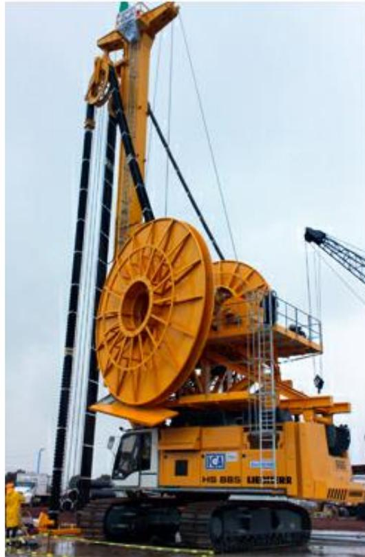
Figura 45. Hidrofresa, excavadora vertical<sup>58</sup>
