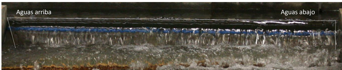
Figura 4.4. Observación en el modelo físico de los ángulos de desviación.
