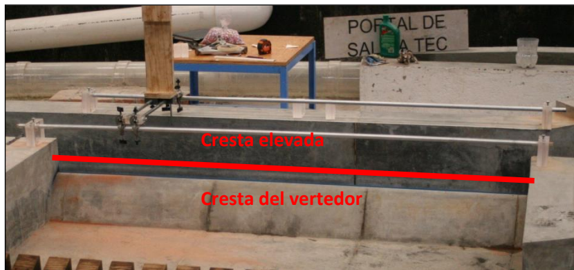
Figura 1.5. Elevación de la cresta del vertedor.
