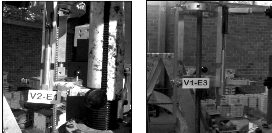
Figura 3.9 Ensayo de probetas del No. 3 y 4, sometidas a cargas monótonas de tensión
