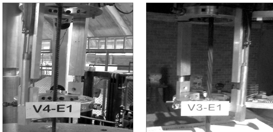
Figura 3.10 Ensayo de probetas de \Phi = 6 mm Y torones de \Phi = 3/8 " de diámetro y sometidas a cargas monótonas de tensión
