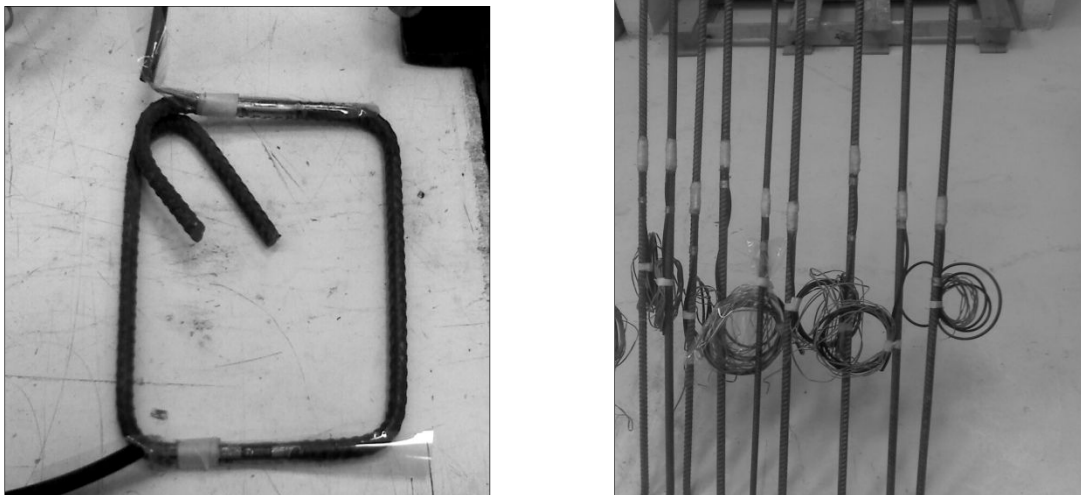
Figura 3.14 Instrumentación Interna del acero de refuerzo transversal y longitudinal mediante deformímetros eléctricos.
