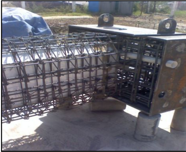
Figura 3.3 Proceso de construcción de un espécimen a escala 1/4. Armado y descimbrado de la columna.
