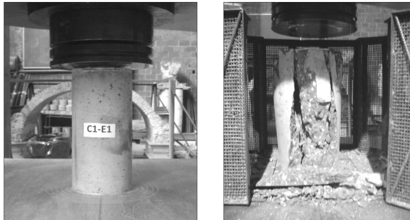
Figura 3.5 Ensayo de cilindros sometidos a compresión uniaxial, antes y después de la prueba.
