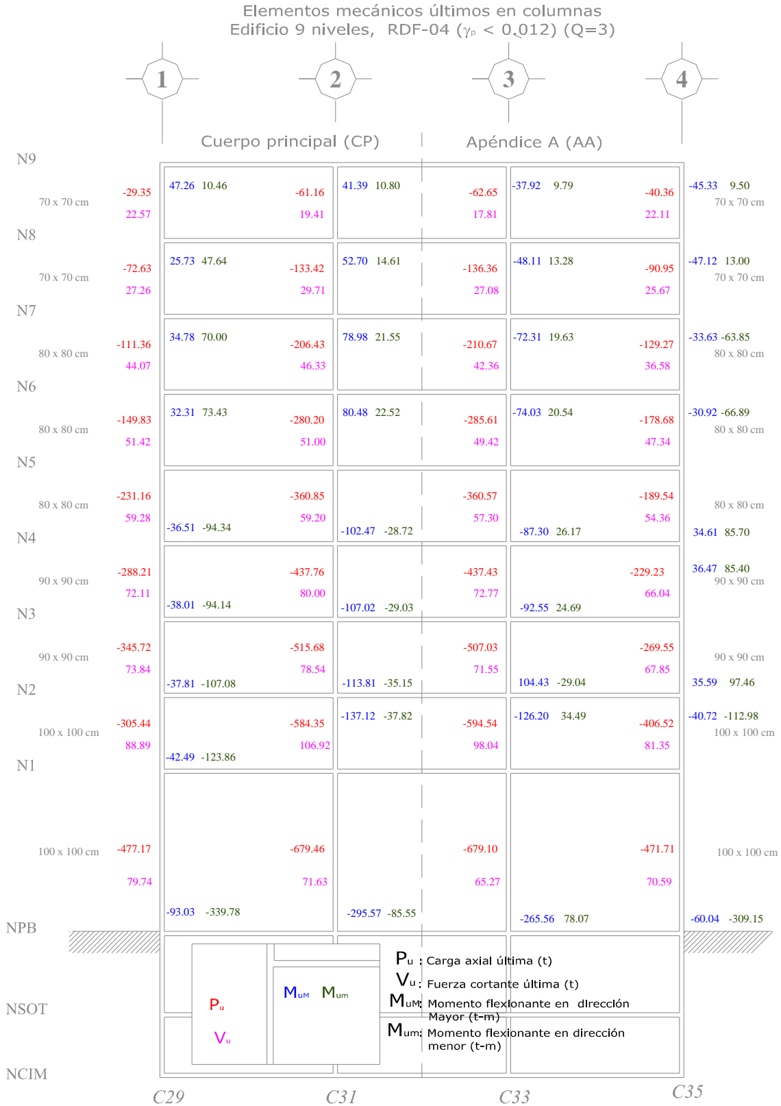
Fig 3.16.- Elementos mecánicos últimos en columnas del eje C, edificio 9 niveles, Apéndice A y Cuerpo Principal de las NTC-Sismo, RDF-04
