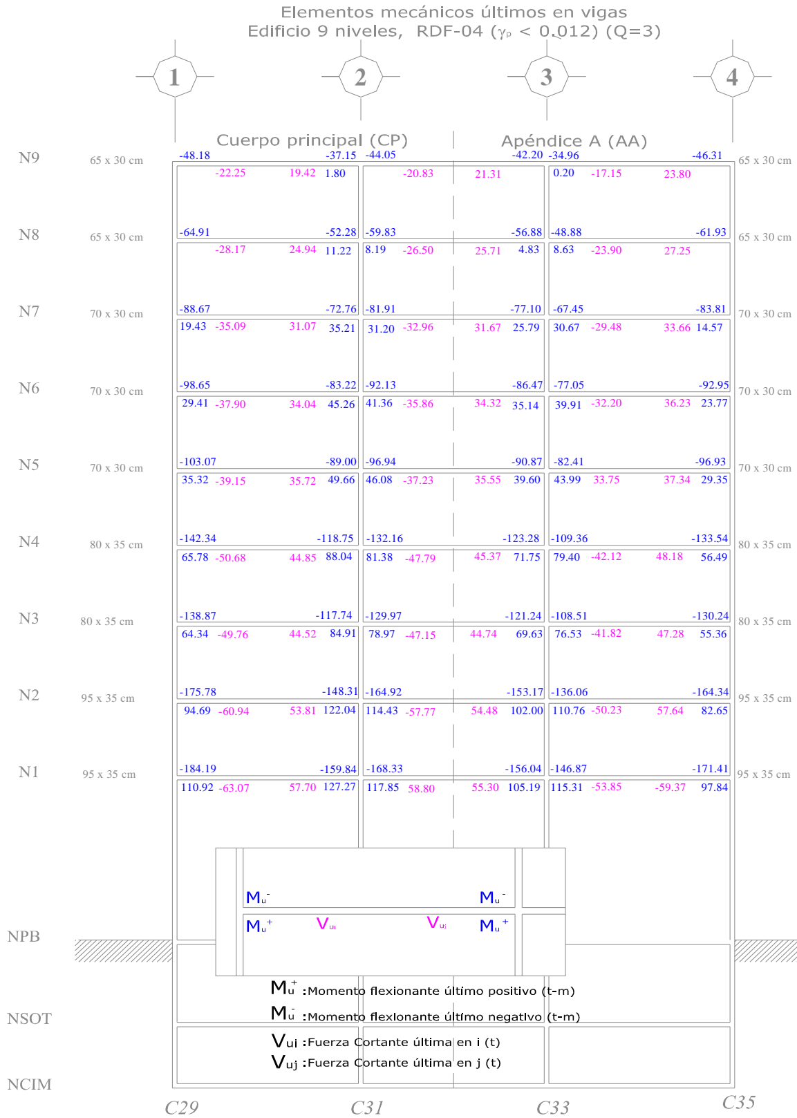
Fig 3.11.- Elementos mecánicos últimos de las vigas del eje C, edificio 9 niveles, Apéndice A y Cuerpo Principal de las NTC-Sismo, RDF-04
