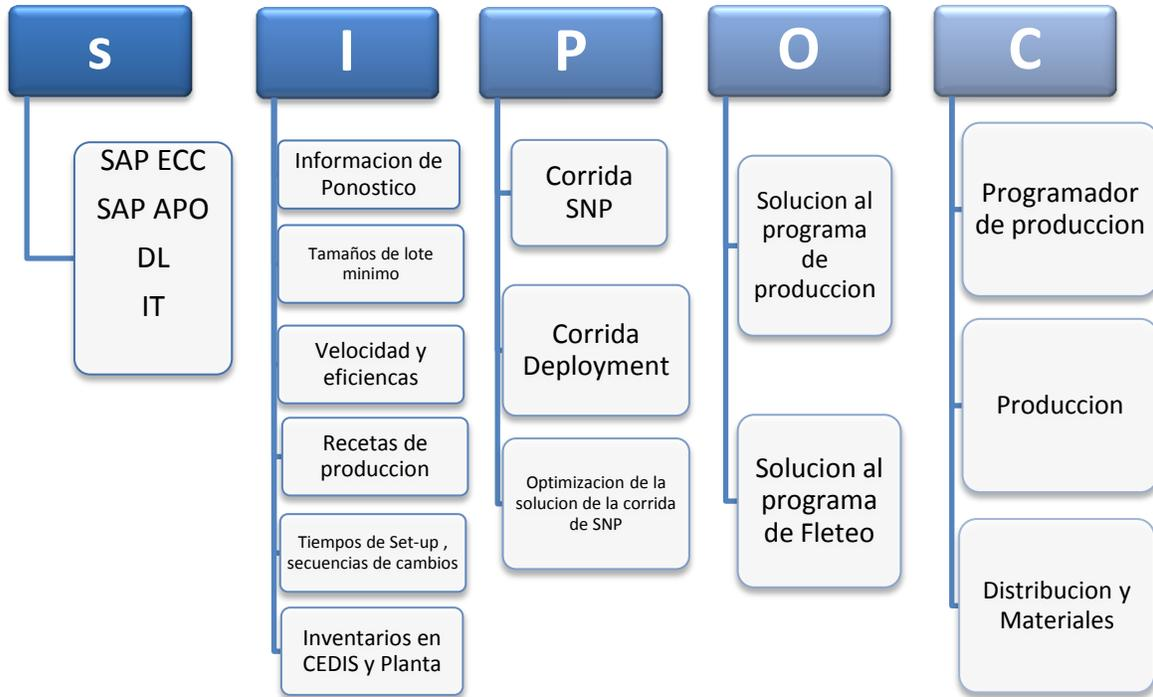
**Fig. 16 – SIPOC del proceso de programación**
