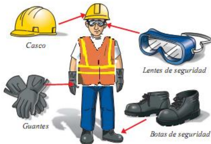
Equipo de protección personal (EPP).
