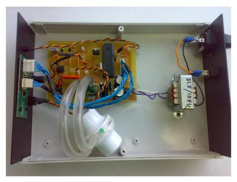
Figura 39. Vista interna superior del Espirómetro de FLujo
