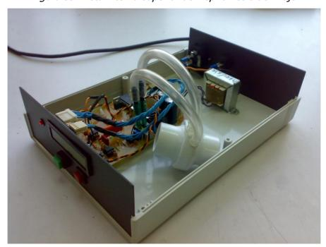
Figura 40, Vista interna frontal del Espirómetro de Flujo.
