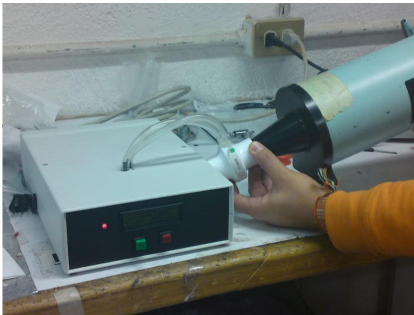
Figura 45. Pruebas de calibración y medición realizadas sobre el prototipo final del espirómetro desarrollado.
