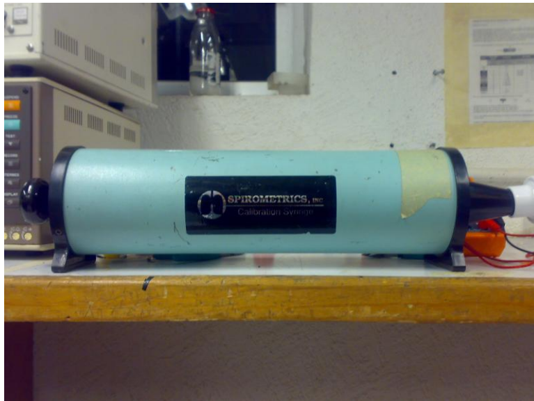
Figura 43. Jeringa de Calibración marca Spirometrics del Departamento de Ingeniería Biomédica del INER.
