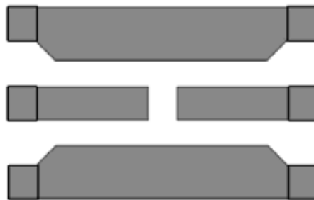
Figura 2.3.5. Estructura de una guía de onda coplanar [2].
