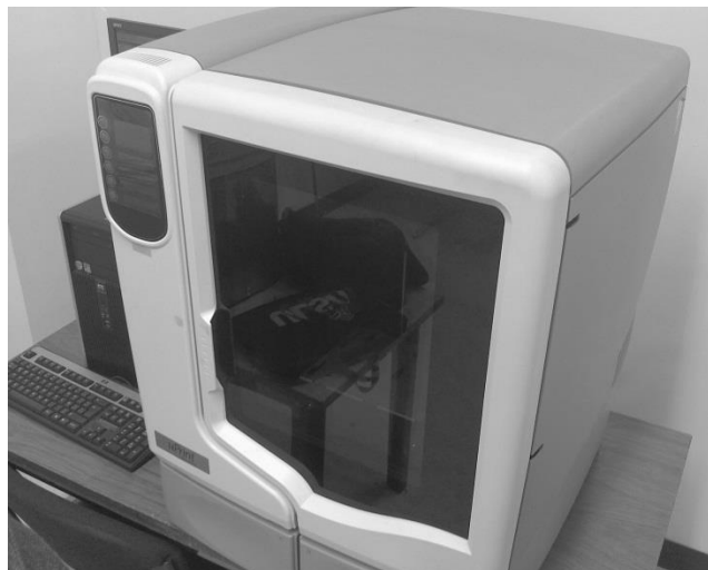
Figura 98. Máquina de impresión en 3D para prototipos rápidos uPrint.
