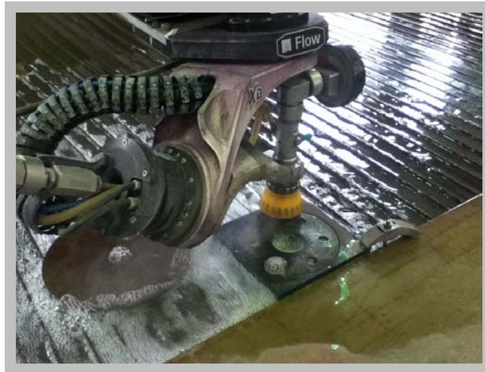
**Figura 30. Fabricación del plato de la flecha de entrada.**
