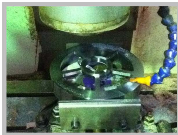
Figura 23. Fabricación de la rueda de balanceo.
