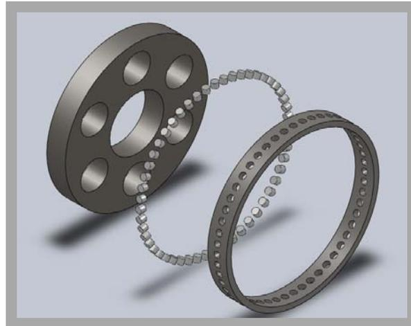
Figura 11. Vista explosiva del engrane móvil.
