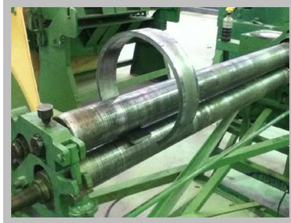
Figura 24. Solera rolada para fabricar el porta-baleros de entrada.
