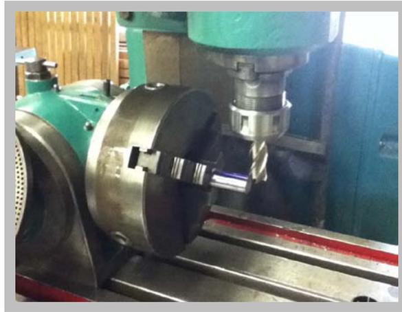
Figura 27. Maquinado de la flecha de entrada.
