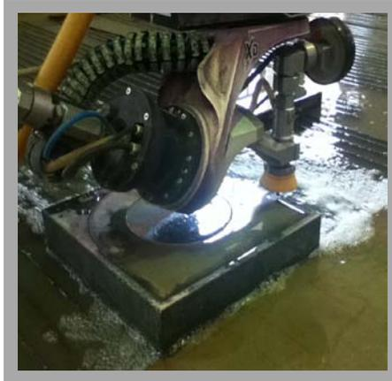
Figura 19. Fabricación del soporte por corte con chorro de agua.
