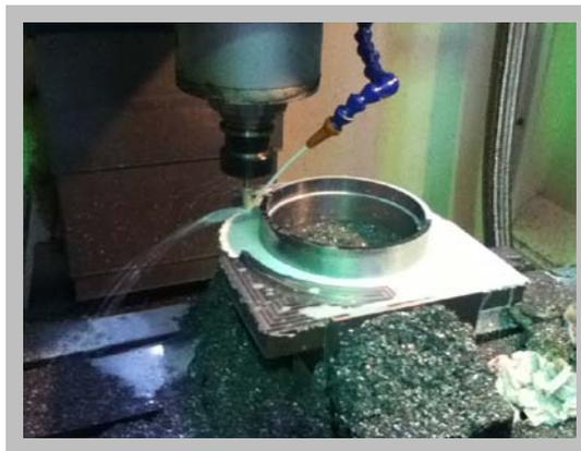
**Figura 20. Fabricación en CNC del soporte.**
