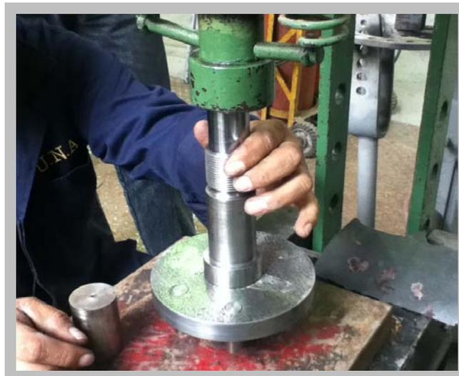
**Figura 31. Ensamble de las diferentes piezas del conjunto de salida.**
