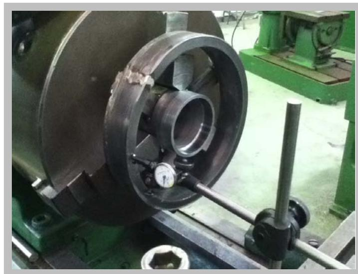
Figura 28. Fabricación del porta-baleros de salida.
