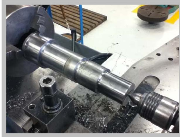
**Figura 29. Flecha de salida.**
